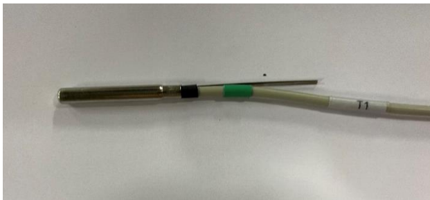
Figuur 12: Temperatuur sensor met veerclip
