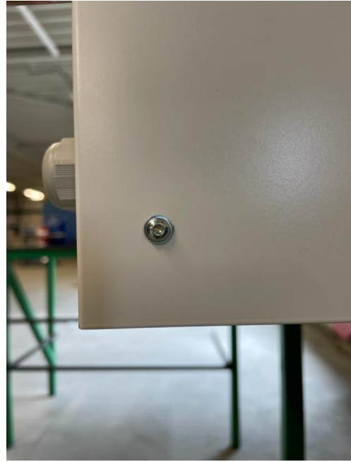
Figuur 29: Bevestiging van bout in zijkant onderkap.
