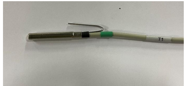
Figuur 11: Temperatuur sensor met omgevouwen clip.
