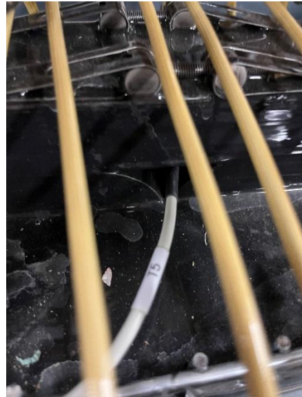
Figuur 26: Inductieblok met temperatuur sensor T5 correct gemonteerd.
